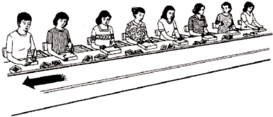
Рисунок 140. Традиционная сборочная линия «с машинным темпом»
