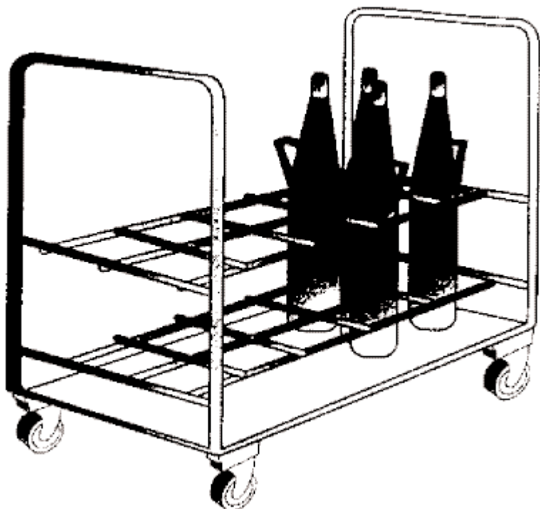
Рисунок 26. Колесная тележка, специально сконструированная для хранения и транспортировки мотоциклетных глушителей
