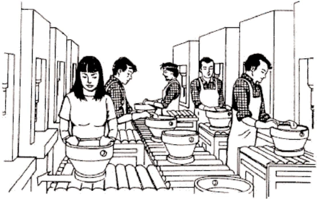
Рисунок 43. Пассивная конвейерная линия для перемещения тяжелых моторных отливок на рабочей высоте
