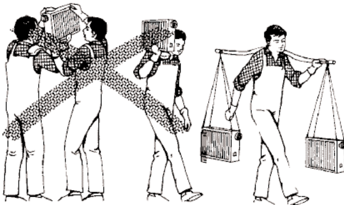
Рисунок 39. Применяйте коромысло для переноса грузов. Минимальная высота подъема повышает эффективность и безопасность работы
