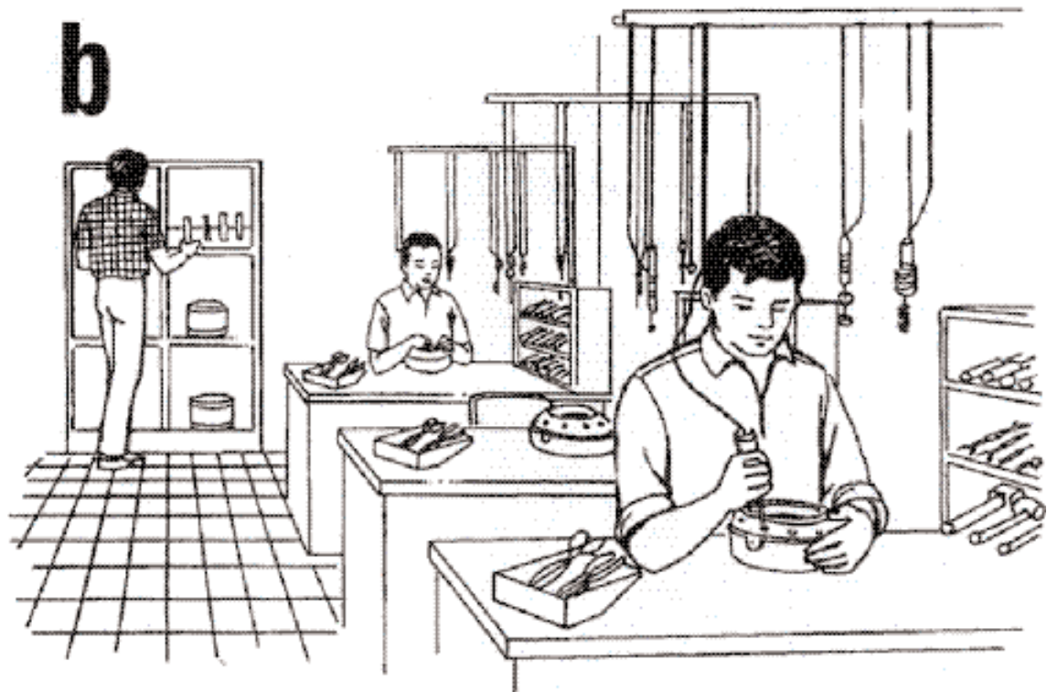
Рисунок 21. Размещение инструментов в соответствии с частотой использования: (а) до (б) после
