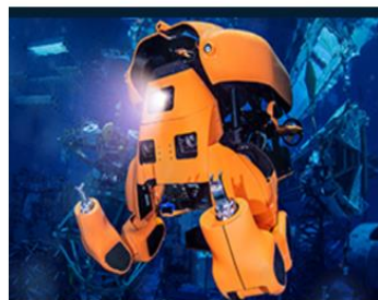
Véhicule sous-marin autonome (AUV) transformé en véhicule opéré à distance par l'adjonction de bras robustes et d'un système de capteurs puissants pour effectuer des travaux sur les gisements pétroliers sous-marins. (Reproduction autorisée par: Houston Mechatronics, Inc.)
