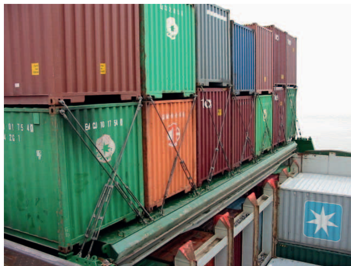
Figura 2.2: Guías de estructuras celulares y barras de trinca en un buque portacontenedores
