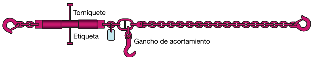
Figura 7.18: Cadena de trinca normalizada con gancho de acortamiento
