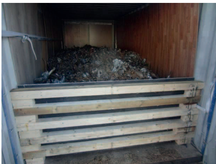
Figura 7.55: Unidad de transporte con paredes revestidas y una barrera de puerta con chatarra
