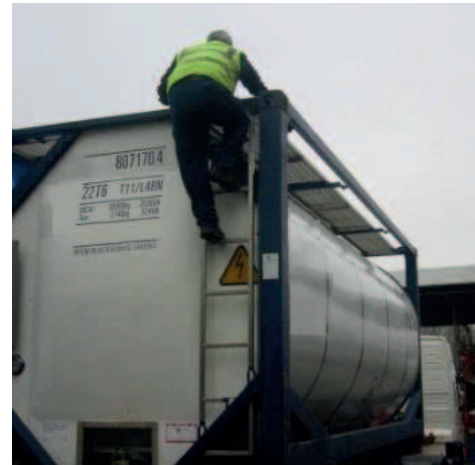
Figura 8.7: Paso de la escalera a la pasarela
