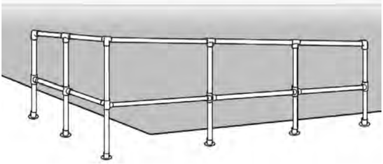
Figure 6. Garde-corps au niveau des angles et des décrochements de l'arête d'un quai
