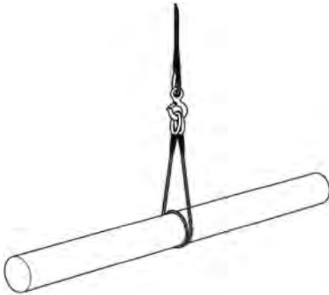
Figure 84. Levage de grumes à l'aide d'une élingue baguée
