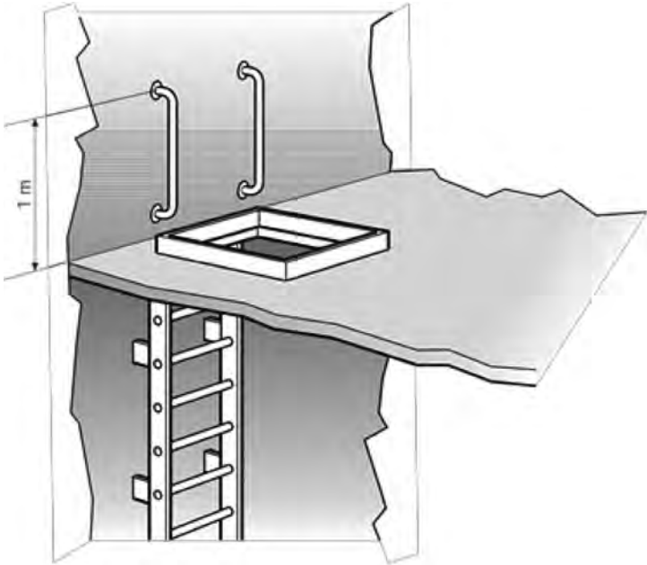
Figure 15. Echelle verticale passant par une ouverture. (Les figures ci-après ne montrent pas forcément tous les équipements de sécurité appropriés. Elles sont données à titre d'exemples.)
