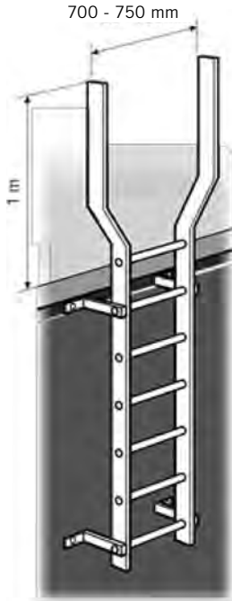
Figure 16. Echelle verticale dépassant de la plate-forme
