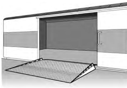
Figure 27. Pont de liaison entre le quai et un wagon
