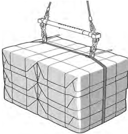
Figure 65. Levage de colis unitaires cerclés avec une sangle ou un feuillard
