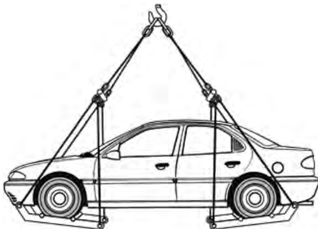
Figure 69. Levage de véhicules au moyen d'élingues
