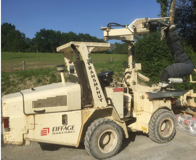
Figures 37 et 38. Système de préhension par succion pour soulever des bordures de trottoir
