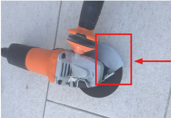
Figure 49. Disqueuse/meuleuse à main correctement protégée
