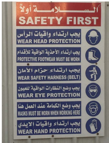
Figure 1. Exemple de panneau de sécurité décrivant les EPI obligatoires
