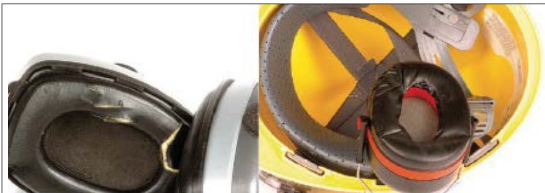
Figures 51 et 52. Casque de protection auditive avec joints fendus et endommagés
