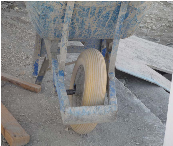
Figure 50. Brouette dont le roulement est mal entretenu
