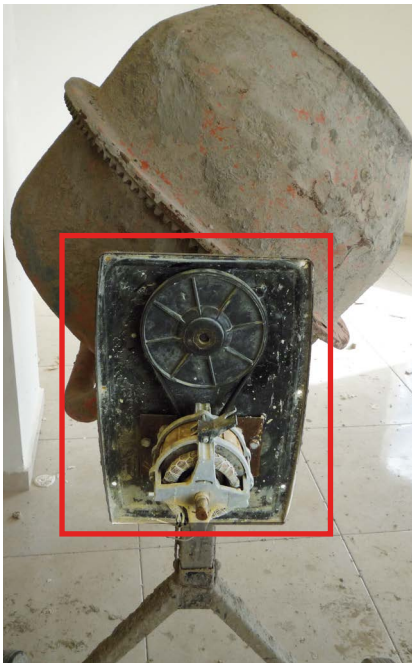
Figure 45. Mécanisme d'entraînement non protégé sur une bétonnière
