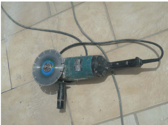
Figure 48. Disqueuse/meuleuse à main sans protection
