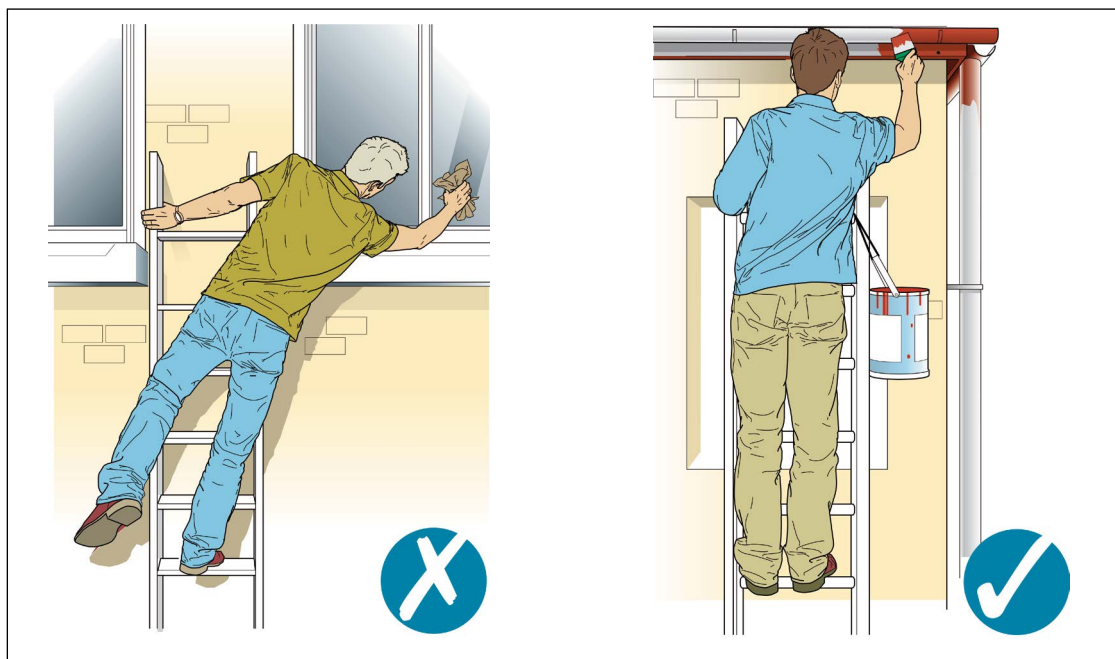
Figure 24. Mauvaise position de travail sur une échelle
