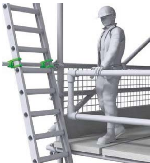
Figure 12. Echelle correctement positionnée, fixée près de la plate-forme d'accès
