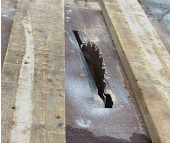
Figure 46. Scie circulaire non protégée
